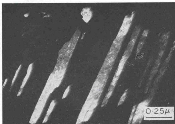
FIG. 5. Mâcles dans l'alliage désordonné choqué.
